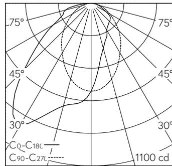
LED 4000 K 16 W 1500 lm-h / CIE Flux 51 81 95 100 100 / A40 nach DIN 5040
