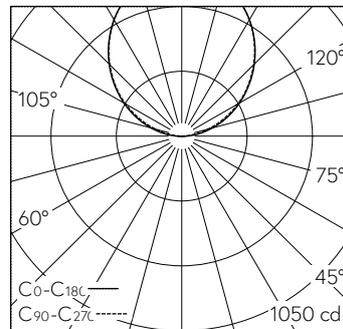
LED 4000 K 24,2 W 2435 lm-h / CIE Flux 0 0 12 1100 / E03 nach DIN 5040
