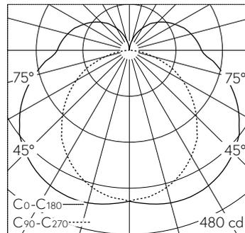
LED 3000 K 18 W 2082 lm-h / CIE Flux 37 66 86 77 100 / B31 nach DIN 5040
