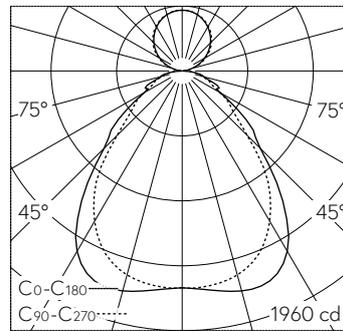
2 x LED 4000 K 36 W 4938 lm-h / CIE Flux 61 86 96 74 100 / B53 nach DIN 5040
