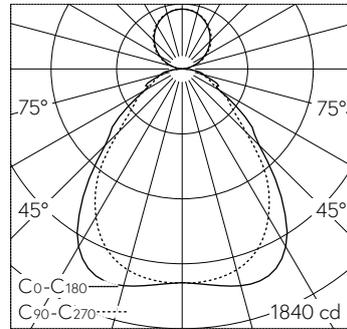
2 x LED 3000 K 36 W 4568 lm-h / CIE Flux 61 86 96 74 100 / B53 nach DIN 5040
