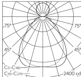
4 x LED 3000 K 48 W 5932 lm-h / CIE Flux 61 85 96 74 100 / B53 nach DIN 5040
