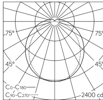
LED 4000 K 39 W 5983 lm-h / CIE Flux 44 74 91 92 100 / A41 nach DIN 5040
