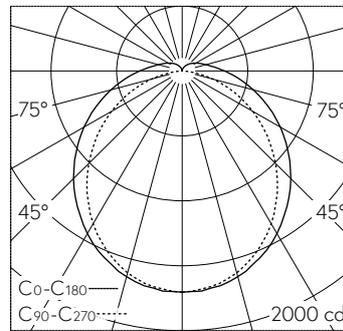
LED 4000 K 35 W 5542 lm-h / CIE Flux 44 74 91 92 100 / A41 nach DIN 5040
