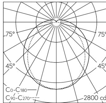
LED 4000 K 50 W 7571 lm-h / CIE Flux 44 74 91 92 100 / A41 nach DIN 5040
