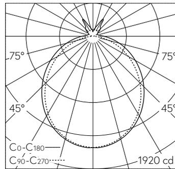
LED 4000 K 35 W 5125 lm-h 108°/98° / CIE Flux 47 77 93 87 100 / B43 nach DIN 50...
