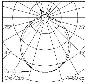
LED 4000 K 27 W 3994 lm-h 108°/98° / CIE Flux 47 77 93 87 100 / B43 nach DIN 50...
