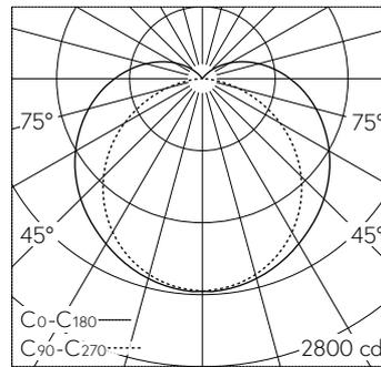
LED 4000 K 70 W 8950 lm-h 160°/110° / CIE Flux 38 66 86 87 100 / B31 nach DIN 5...
