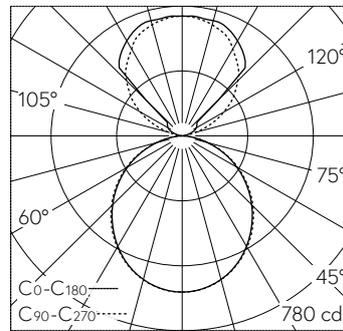
4 x LED 4000 K 23 W 2846 lm-h 106°/266° / CIE Flux 48 80 96 60 100 / C44 nach ...
