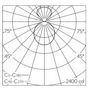
$5 \times \text{LED } 4000 \times 31 \text{ W } 3686 \text{ lm-h } 280^{\circ} / 294^{\circ} / \text{CIE Flux } 48 80 96 65 100 / B44 nach D...$
