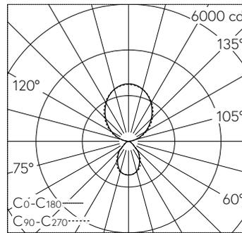
LED 5 x 4000 K 64 W 8565 lm-h / CIE Flux 69 91 98 28 100 / D63 nach DIN 5040
