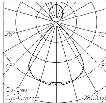
LED 4000 K 30 W 4289 lm-h / CIE Flux 94 100 100 68 100 / B83 nach DIN 5040
