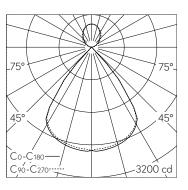
LED 3000 K 35 W 4698 lm-h / CIE Flux 94 100 100 73 100 / B83 nach DIN 5040
