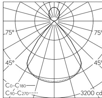
LED 3000 K 35 W 4698 lm-h / CIE Flux 94 100 100 73 100 / B83 nach DIN 5040
