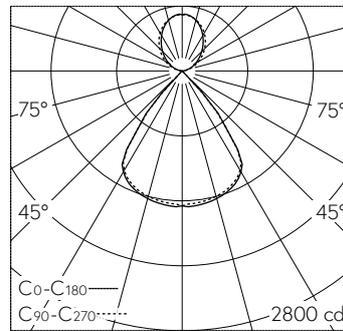
LED 3000 K 23 W 3336 lm-h / CIE Flux 94 100 100 59 100 / C83 nach DIN 5040
